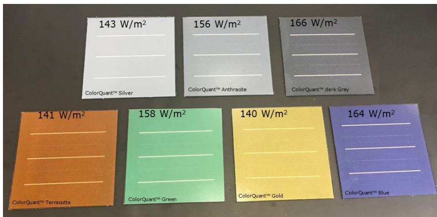
采用 ColorQuant™ 技术上的太阳能电池组件示例。未上色的参照组件功率密度为 175 W/m 2
