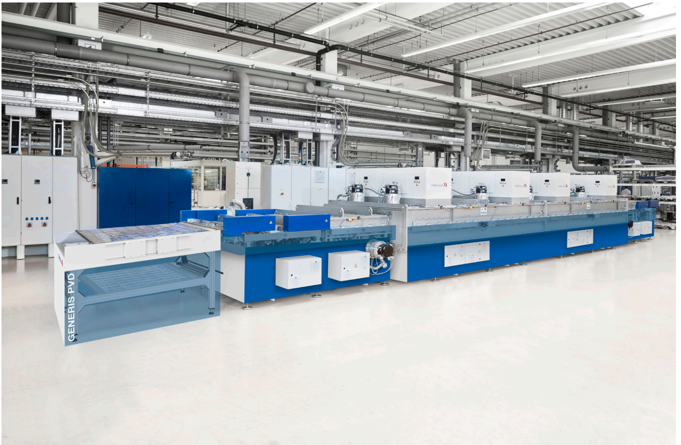
照片：安装期间用于异质结太阳能电池GENERIS PVD的在线溅射设备
