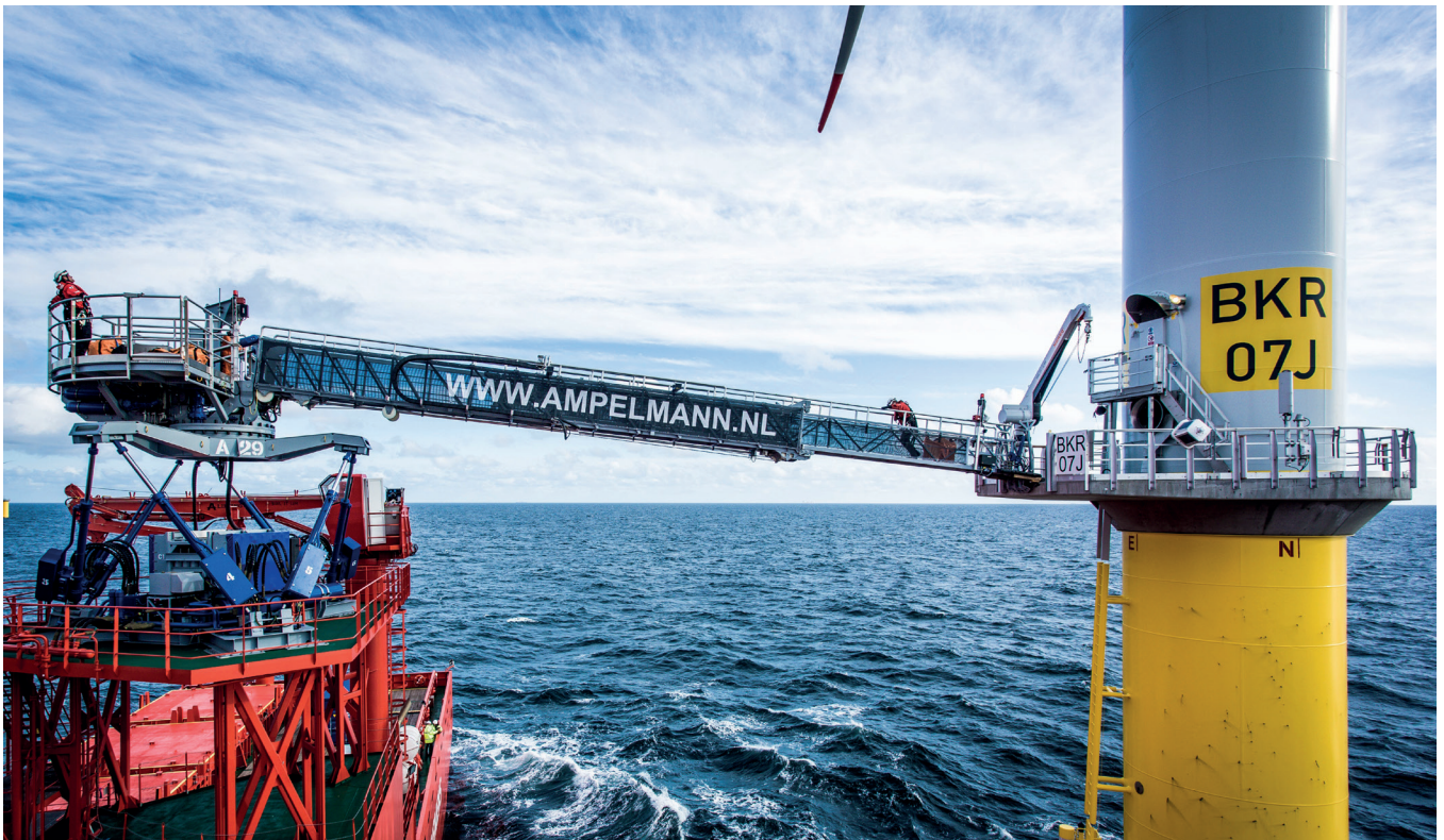
Ampelmann A-type gangway system
